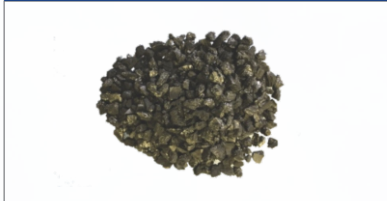
Elemento de Filtro (Canto Rodado / Arena / Carbón Activado)
