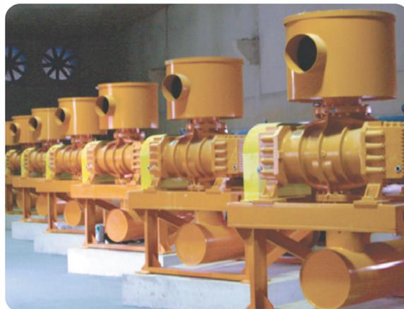
Todos os conjuntos dispõem de acessórios especiais para aplicação em sistemas de aeração por ar difuso: bases e acoplamentos, silenciadores, filtro de ar, suportes antivibração, manômetros, válvulas de retenção, válvula de segurança e cabines de isolamento acústico.
